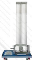
MEMT-1. Rozkład ciśnienia promieniowego w łożysku poprzecznym
