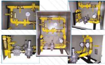
GBT. Trenażer palników gazowych z wymuszonym obiegiem powietrza
