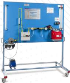
GBT. Trenażer palników gazowych z wymuszonym obiegiem powietrza
