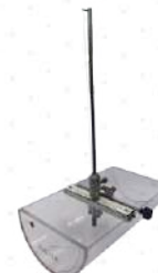
FME11-B. Demonstracja wysokości metacentrycznej ciała pływającego w kształcie litery "U"
