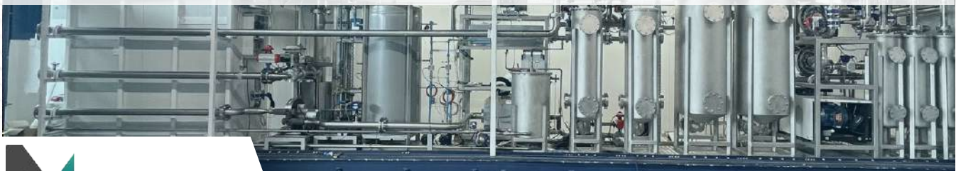
MOF4AIR. Instalacja pilotażowa do wychwytywania adsorpcyjnego CO 2 . [NORWEGIA, TURCJA and FRANCJA]
