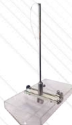
FME11-A. Demonstracja wysokości metacentrycznej ciała pływającego w kształcie litery "V"
