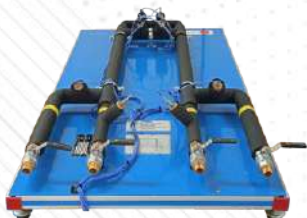
TICC. Koncentryczny rurowy wymiennik ciepła dla TICC
