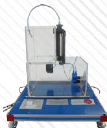
RYC-C. Moduł kontroli natężenia przepływu
