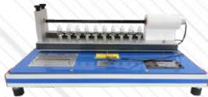
TXC/SE. Moduł przenoszenia ciepła przez powierzchnię rozwiniętą (żebrowaną)
