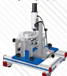
MEMT-1. Rozkład ciśnienia promieniowego w łożysku poprzecznym
