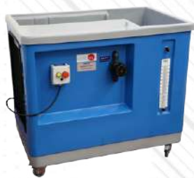
FME00. Hydrauliczny system zasilania
