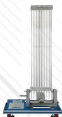
MEMT-1. Rozkład ciśnienia promieniowego w łożysku poprzecznym
