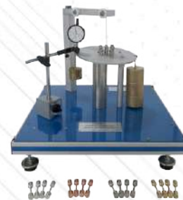
▶ STH. Stanowisko badania naprężeń w próbkach z różnych materiałów
