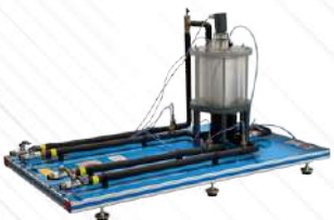
TIVE. Wymiennik ciepła z płaszczem wodnym dla TICC
