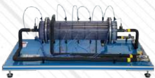
TICT. Płaszczowo-rurowy wymiennik ciepła dla TICC
