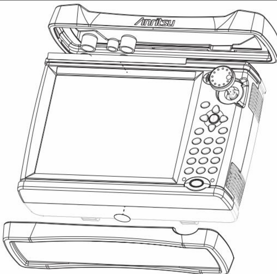
Rysunek 6-11. Demontaż osłon gumowych i pokręteł
