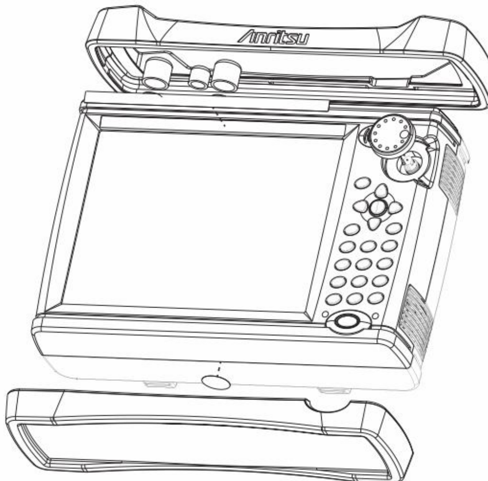
Rysunek 6-1. Demontaż osłon zabezpieczających i pokręła
