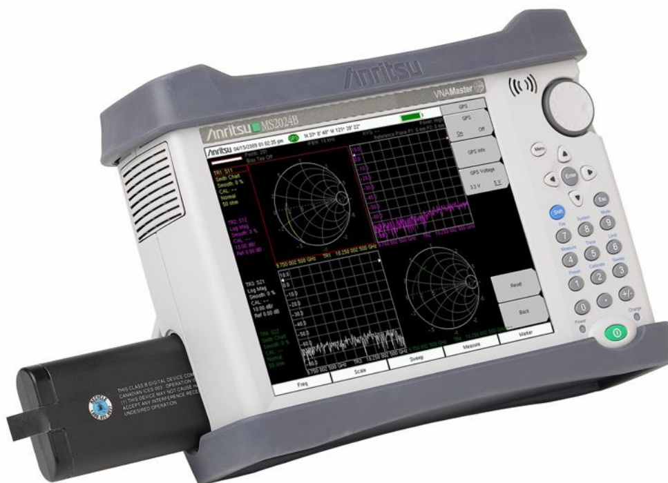
Rysunek 5-2. Wkładanie i wyjmowanie akumulatorka
