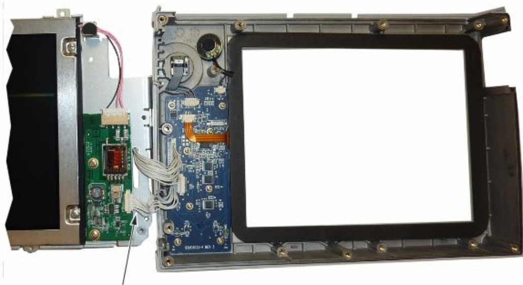
Rysunek 6-24. Wymiana zespołu LCD
