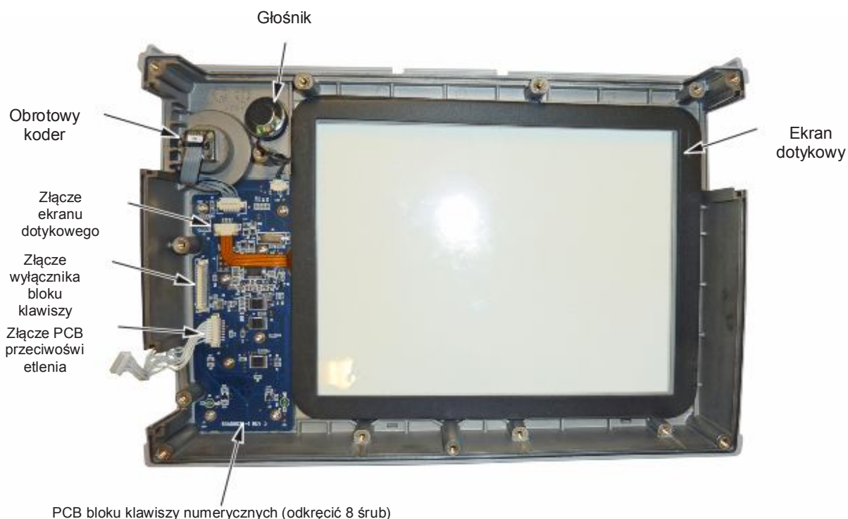
Rysunek 6-27. Wymiana bloku klawiszy numerycznych z panela przedniego
