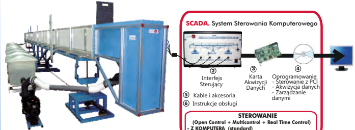
① CFGC. Kanały przepływowe (przekrój: 300 x 450 mm).
