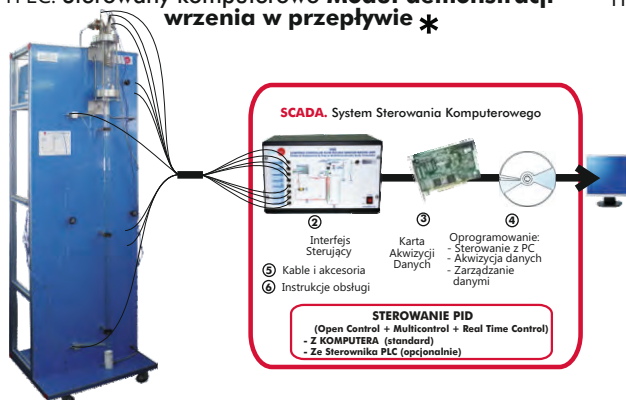
TFEC. Sterowany komputerowo Moduł demonstracji wrzenia w przepływie *
